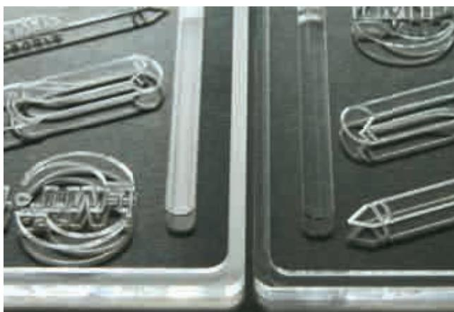
Usinage avec une fraise ED ou CRISTAL
